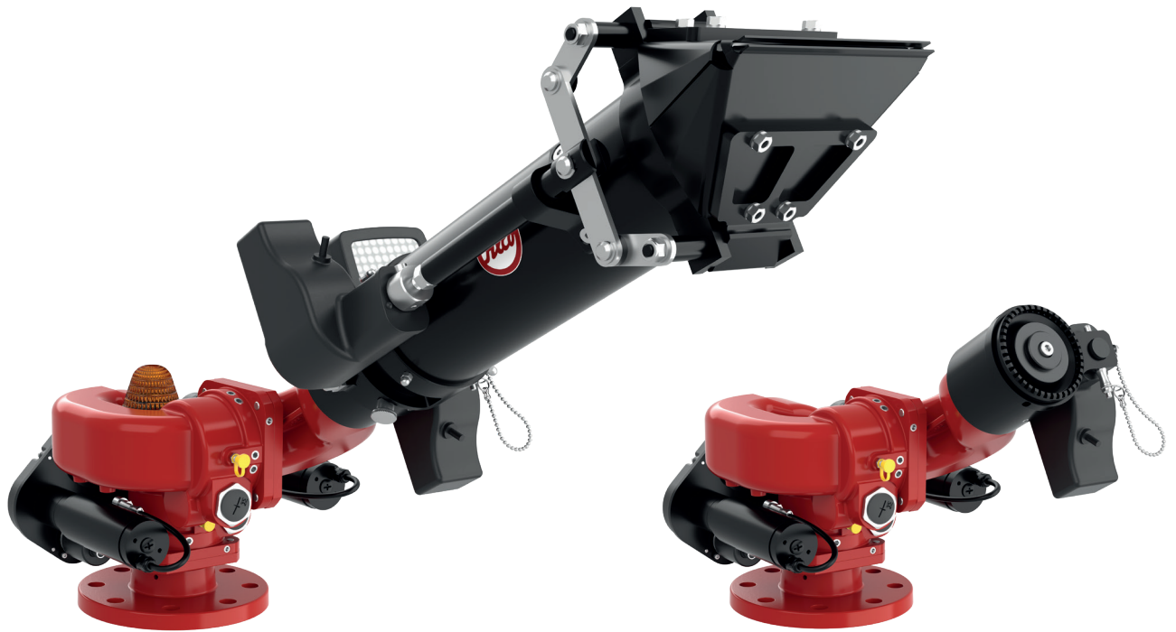
APF 2-DC EVO mit Mehrweckdüse MZ 2000, Schaumaufsatz SWA 2000 DC mit Deflektor, Manometer und Blitzleuchte*
