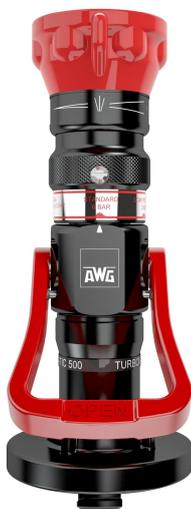
Das AWG Hohlstrahlrohr Turbomatic reguliert automatisch Wasserstrahl und Durchfluss bei Druckschwankungen. Intuitive Bedienung und robuste Bauweise sorgen für ein Plus an Zuverlässigkeit, Sicherheit und Schnelligkeit.
