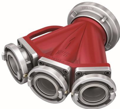
Die AWG Sammelstücke dienen dazu, die Löschwasser/Löschmittelströme aus drei Zuleitungen zusammen zu führen. Das Zweifach-Sammelstück der Serie Trinkwasser- & Leitungsschutz ist mit zwei einzelnen Rückschlagklappen ausgestattet. In die Kupplung an den Eingängen des Sammelstücks sind jeweils zwei Belüfter integriert. In Kombination mit dem AWG Systemtrenner B-FW eignet es sich zur Advanced-Absicherung – dem zuverlässigen Schutz vor Schäden und Verunreinigungen durch Unterdruck.
