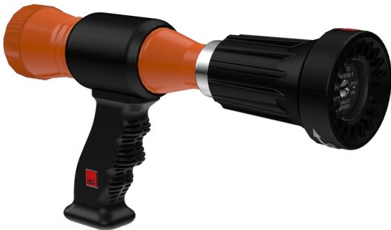
Die AWG HS-Strahlrohre zeichnen sich durch ihre einfache Handhabung und ihre Robustheit aus. Durch Drehen des Schaltkopfes kann stufenlos von Absperrung über Vollstrahl kontinuierlich auf Sprühstrahl zwischen 0° und 120° Sprühwinkel umgeschaltet werden. Der Schaltkopf ist aus Gummi und verchromtem Messing gefertigt, das Rohrstück aus extrem schlagzähem Kunststoff.
