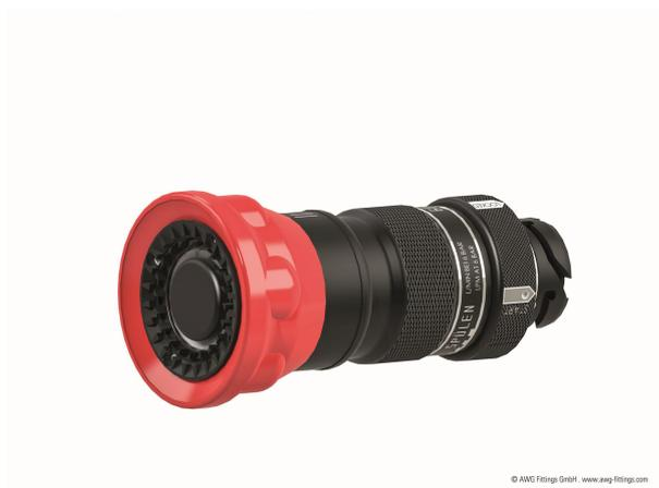
Die AWG Turbo-Twist Hohlstrahldüsen verfügen über die bewährten Features der AWG Turbo-Spritzen: das Öffnen und Schließen über einen Bügelgriff, die StrahlformEinstellung von Vollstrahl (0°) hin zu Sprühstrahl (120°) erfolgt durch Drehen des Strahlrohrkopfes. Eine wirkungsvolle Hilfe zum Ertasten der eingestellten Strahlform auch bei schlechter Sicht ist der Pointer.
