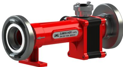
Der AWG Zumischer dient zur Ansaugung flüssigen Löschmittelzusätze oder Schaummittelkonzentrate nach dem Venturi-Prinzip. Zumischer der Modellreihe „L“ sind besonders leicht und benötigen deshalb keinen Griff. Die Zumischrate kann zwischen 1 und 6 % eingestellt werden.
