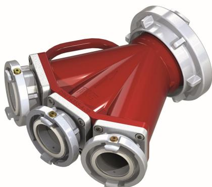
Die AWG Sammelstücke dienen dazu, die Löschwasser/Löschmittelströme aus drei Zuleitungen zusammen zu führen. Das Dreifach-Sammelstück der Serie Trinkwasser- & Leitungsschutz ist mit drei einzelnen Rückschlagklappen ausgestattet. In die Kupplung an den Eingängen des Sammelstücks sind jeweils zwei Belüfter integriert. In Kombination mit dem AWG Systemtrenner B-FW eignet es sich zur Advanced-Absicherung – dem zuverlässigen Schutz vor Schäden und Verunreinigungen durch Unterdruck.
