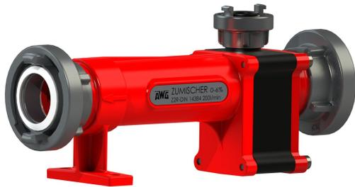
Der AWG Zumischer dient zur Ansaugung flüssigen Löschmittelzusätze oder Schaummittelkonzentrate nach dem Venturi-Prinzip. Zumischer der Modellreihe „L“ sind besonders leicht und benötigen deshalb keinen Griff. Die Zumischrate kann zwischen 1 und 6 % eingestellt werden.
