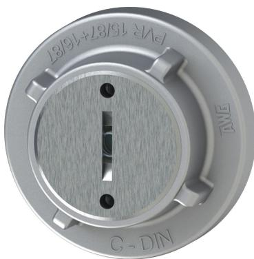
Blindkupplungen werden zum Verschluss von Leitungen oder Armaturen verwendet. Sie dienen dazu, diese vor Verunreinigungen und Verschmutzungen zu schützen. Ausgestattet mit einem Ventil, entlüftet die Blindkupplung die Rohrleitung automatisch.
