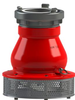
Der AWG Saugkorb dient als Eingang an einer Saugleitung für Löschwasser aus einem offenen Gewässer. Saugkörbe mit Rückschlagventil und Entleereinrichtung verhindern ein Abreißen der Flüssigkeitssäule bei Unterbrechung des Saugvorgangs und ermöglichen ein Auffüllen der Saugleitung. Durch die seilbediente Entleereinrichtung wird das Rückschlagventil geöffnet und der Saugschlauch entleert.
