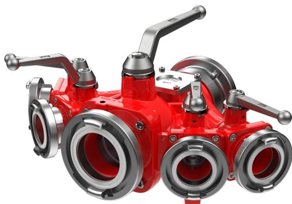
Die AWG Verteiler dienen dazu, das Löschwasser aus einer Leitung in fünf Schlauchleitungen aufzuteilen und somit eine optimale Löschwasserversorgung zu erhalten. Als Absperrorgan dient hier ein Kugelhahn, welches sich schnell und einfach öffnen lässt.
