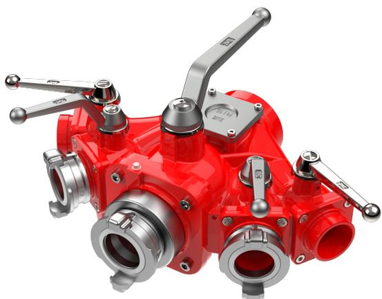
Die AWG Verteiler dienen dazu, das Löschwasser aus einer Leitung in fünf Schlauchleitungen aufzuteilen und somit eine optimale Löschwasserversorgung zu erhalten. Als Absperrorgan dient hier ein Kugelhahn, welches sich schnell und einfach öffnen lässt.
