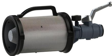
Die AWG Mittelschaumrohre nach DIN EN 16712-3 dienen der Ausbringung von Löschschaum, im Speziellen in Form von Mittelschaum. Das Wasser-/Schaummittelgemisch wird unter Ansaugen von Luft verschäumt und im freien Strahl ausgebracht. Durch das integrierte Veredlersieb wird eine hohe Verschäumung ermöglicht. Ausgestattet mit der Kugelhanabsperung ist dem Strahlrohrführer möglich die Löschmittelabgabe zu unterbrechen.
