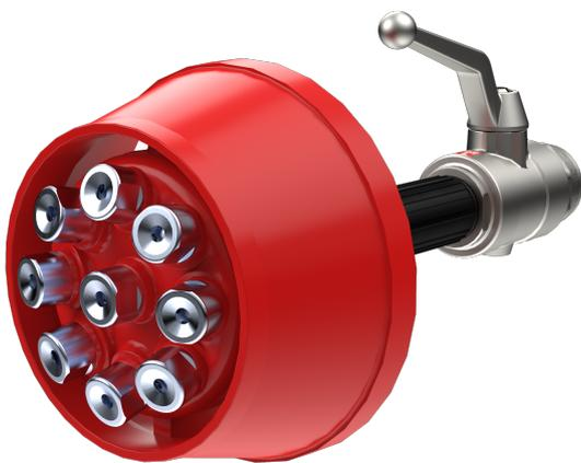
Das AWG Zerstäuberstrahlrohr mit Dralldüse findet ihren perfekten Einsatzzweck bei der Bekämpfung von brennenden Flüssigkeiten, wie Öle oder Lacke. Durch die intensive Wasserzerstäubung lässt sich sowohl ein guter Löscheffekt wie auch eine starke Kühlwirkung erbringen.
