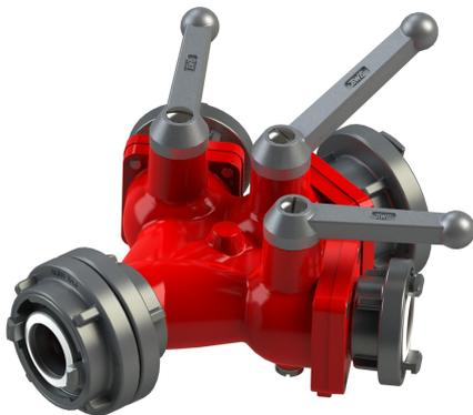
Die AWG Verteiler dienen dazu, das Löschwasser aus einer Leitung in drei Schlauchleitungen aufzuteilen und somit eine optimale Löschwasserversorgung zu erhalten. Als Absperrorgan dient hier ein Kugelhahn, welches sich schnell und einfach öffnen lässt. Ausgestattet mit Übergangsstück B-C und Kette
