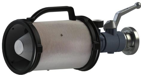
Die AWG Mittelschaumrohre nach DIN EN 16712-3 dienen der Ausbringung von Löschschaum, im Speziellen in Form von Mittelschaum. Das Wasser-/Schaummittelgemisch wird unter Ansaugen von Luft verschäumt und im freien Strahl ausgebracht. Durch das integrierte Veredlersieb wird eine hohe Verschäumung ermöglicht. Ausgestattet mit der Kugelhanabsperung ist dem Strahlrohrführer möglich die Löschmittelabgabe zu unterbrechen.
