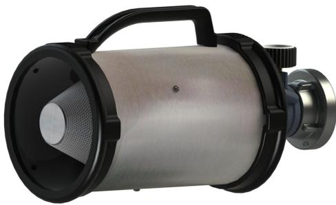
Die AWG Mittelschaumrohre nach DIN EN 16712-3 dienen der Ausbringung von Löschschaum, im Speziellen in Form von Mittelschaum. Das Wasser-/Schaummittelgemisch wird unter Ansaugen von Luft verschäumt und im freien Strahl ausgebracht. Durch das integrierte Veredlersieb wird eine hohe Verschäumung ermöglicht.
