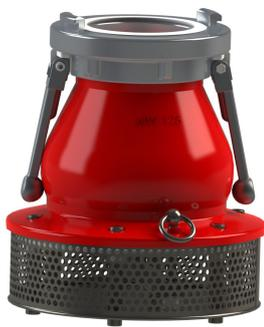
Der AWG Saugkorb dient als Eingang an einer Saugleitung für Löschwasser aus einem offenen Gewässer. Saugkörbe mit Rückschlagventil und Entleereinrichtung verhindern ein Abreißen der Flüssigkeitssäule bei Unterbrechung des Saugvorgangs und ermöglichen ein Auffüllen der Saugleitung. Durch die seilbediente Entleereinrichtung wird das Rückschlagventil geöffnet und der Saugschlauch entleert.
