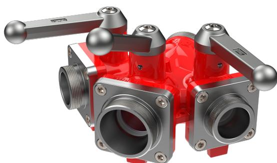
Die AWG Verteiler dienen dazu, das Löschwasser aus einer Leitung in drei Schlauchleitungen aufzuteilen und somit eine optimale Löschwasserversorgung zu erhalten. Als Absperrorgan dient hier ein Kugelhahn, welches sich schnell und einfach öffnen lässt.
