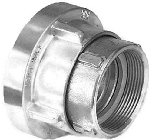
Knaggenteile mit Gewindestutzen für Rohre, Armaturen und Apparate, wenn letztere in einer gewissen Position gehalten werden sollen und sich beim Kuppeln nicht drehen dürfen. Bei vorhandener zusätzlicher Verriegelung nur anwenden gegen beschichtete Aluminiumkupplungen.
