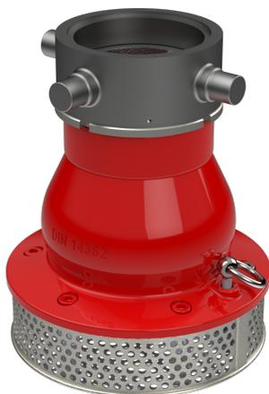
Der AWG Saugkorb dient als Eingang an einer Saugleitung für Löschwasser aus einem offenen Gewässer. Saugkörbe mit Rückschlagventil und Entleereinrichtung verhindern ein Abreißen der Flüssigkeitssäule bei Unterbrechung des Saugvorgangs und ermöglichen ein Auffüllen der Saugleitung. Durch die seilbediente Entleereinrichtung wird das Rückschlagventil geöffnet und der Saugschlauch entleert.
