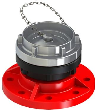
Dachflansch zum Befestigen eines Monitors auf dem Aufbaudach des Fahrzeuges. Verbindung zur Rohrleitung über einen Flansch.
