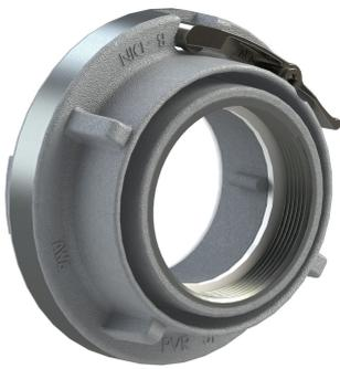
Knaggenteile mit Gewindestutzen für Rohre, Armaturen und Apparate, wenn letztere in einer gewissen Position gehalten werden sollen und sich beim Kuppeln nicht drehen dürfen. Bei vorhandener zusätzlicher Verriegelung nur anwenden gegen beschichtete Aluminiumkupplungen.
