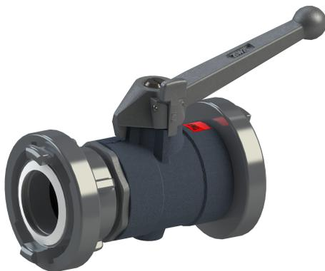
Zum Absperrn von Angriffsleitungen beim Verlängern bzw. zum Abstellen der Förderleitung beim Befüllen. Die Schaltarretierung verhindert ein unbeabsichtigtes Absperrn, daher ideal geeignet für das Schlauchpaket.
