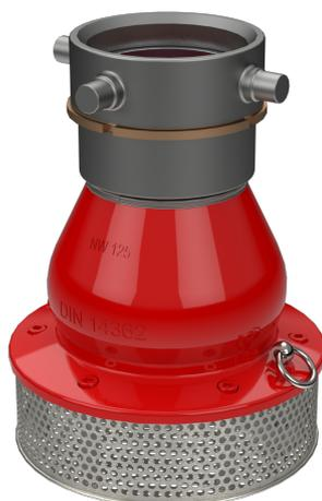
Der AWG Saugkorb dient als Eingang an einer Saugleitung für Löschwasser aus einem offenen Gewässer. Saugkörbe mit Rückschlagventil und Entleereinrichtung verhindern ein Abreißen der Flüssigkeitssäule bei Unterbrechung des Saugvorgangs und ermöglichen ein Auffüllen der Saugleitung. Durch die seilbediente Entleereinrichtung wird das Rückschlagventil geöffnet und der Saugschlauch entleert.
