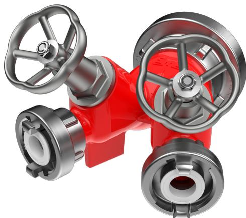
Die AWG Verteiler dienen dazu, das Löschwasser aus einer Leitung in zwei Schlauchleitungen aufzuteilen und somit eine optimale Löschwasserversorgung zu erhalten. Die Ventilabspernung ermöglicht ein sanftes öffnen und schließen der Abgänge.
