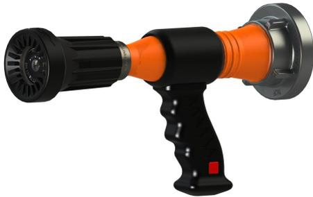
Die AWG HS-Strahlrohre zeichnen sich durch ihre einfache Handhabung und ihre Robustheit aus. Durch Drehen des Schaltkopfes kann stufenlos von Absperrung über Vollstrahl kontinuierlich auf Sprühstrahl zwischen 0° und 120° Sprühwinkel umgeschaltet werden. Der Schaltkopf ist aus Gummi und verchromtem Messing gefertigt, das Rohrstück aus extrem schlagzähem Kunststoff.
