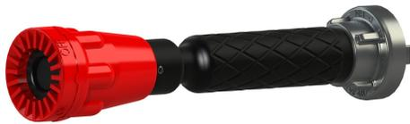
Die AWG HS-Strahlrohre zeichnen sich durch ihre einfache Handhabung und ihre Robustheit aus. Durch Drehen des Schaltkopfes kann stufenlos von Absperrung über Vollstrahl kontinuierlich auf Sprühstrahl zwischen 0° und 120° Sprühwinkel umgeschaltet werden. Der Schaltkopf ist aus Gummi und verchromtem Messing gefertigt, das Rohrstück aus extrem schlagzähem Kunststoff.
