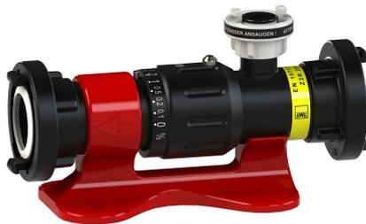
Der AWG Zumischer Feindosierung, nach DIN EN 16712-1 dient zur Ansaugung flüssigen Löschmittelzusätze oder Schaummittelkonzentrate nach dem Venturi-Prinzip. Er überzeugt nicht nur durch die zusätzlichen sehr geringen Zumischerten von 0 - 0,1 - 0,2 - 0,5 - 1 - 2 - 3 - 4 - 5 - 6 % sondern auch durch den stabilen Standfuß. Die drehbar gelagerte Zumischeinheit garantiert außerdem den knickfreien Anschluss der Schaummittelzuleitung in alle Richtungen.
