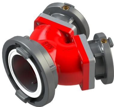
Die AWG Sammelstücke dienen dazu, die Löschwasser/Löschmittelströme aus zwei Zuleitungen zusammen zu führen. Das Zweifach-Sammelstück der Serie Trinkwasser- & Leitungsschutz ist mit zwei einzelnen Rückschlagklappen ausgestattet. In die Kupplung an den Eingängen des Sammelstücks sind jeweils zwei Belüfter integriert. In Kombination mit dem AWG Systemtrenner B-FW eignet es sich zur Advanced-Absicherung – dem zuverlässigen Schutz vor Schäden und Verunreinigungen durch Unterdruck.
