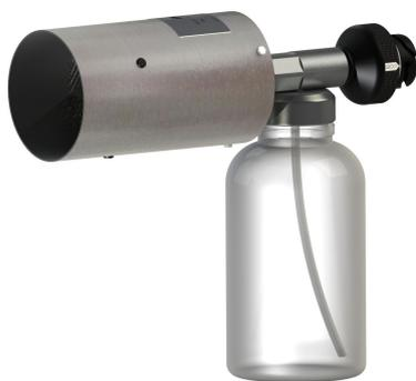
Das AWG Systemstrahlrohr Turbo-Twist bietet für die Ausbringung von Wasser-Schaummittelgemisch, eine passende Lösung. Die Mittelschaumdüse M0,4 ist ein ein selbstansaugendes Schaumrohr mit integriertem 2 l-Schaumbehälter zur erzeugung von Mittelschaum.
