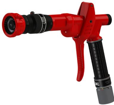
Die AWG Turbo-Pistole 2130 HD kombiniert die Vorzüge der Turbo-Spritzen mit denen der Pistolen - auch beim Einstz unter Hochdruck. Die Durchflussmenge ist einstellbar je nach Eingangsdruck. Der Wechsel zwischen Voll- und Sprühstrahl erfolgt analog wie bei den Turbospritzen durch das Drehen des Strahlrohrkopfes. Die Turbo-Pistole 2130 HD verfügt über eine auch unter Druck drehbare Überwurfmutter am Eingang. Sie kann vorzugsweise in Verbindung mit Schläuchen DN 19-25-33 eingesetzt werden.
