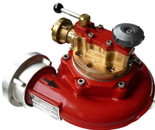
Der AWG Turbo-Schaummittelzumischer TR 400 dient zur Erzeugung eines Schaummittel-Löschwasser-Gemisches, wobei das Schaummittel durch eine Pumpe unter Druck dem Wasser zugemischt wird. Eine Zumischung von 1-6% ist hier möglich. Die Pumpe wird über eine Turbine angetrieben, die sich im Löschwasserstrom befindet. Dadurch treten beim TR400 geringere Druckverluste auf, als bei der normalen Zumischung von Schaummitteln mit Zumischern.
