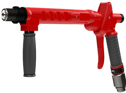
Die AWG Hochdruckpistole HDP 1 zeichnet sich durch die Erzeugung von extrem feinen Tröpfchen sowie einer stufenlosen Veränderung von Sprühstrahl auf Vollstrahl mit Zwischenstellung Flachstrahl aus. Durch die eingebaute wasserhydraulische Schließdämpfung ist ein selbsttätiges, sanftes und druckstoßfreies Schließen möglich.
