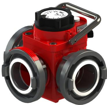
Das AWG Druckbegrenzungsventil dient dazu, Schlauchleitungen und Armaturen vor Überbeanspruchungen zu schützen. Das Druckbegrenzungsventil soll hierfür den Betriebsdruck begrenzen. Wird der eingestellte Sollwert überschritten, so steuert das Ventil seitlich Wasser ins Freie ab. Bei nur 0,5 bar über eigestellten Druck, öffnet das Druckbegrenzungsventil innerhalb von nur 0,1 Sekunden, um den Druck anzupassen. Die Druckeinstellung zwischen 2 und 16 bar erfolgt am selbstleuchtenden Manometer.
