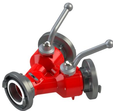
Die AWG Verteiler dienen dazu, das Löschwasser aus einer Leitung in zwei Schlauchleitungen aufzuteilen und somit eine optimale Löschwasserversorgung zu erhalten. Als Absperrorgan dient hier ein Kugelhahn, welches sich schnell und einfach öffnen lässt.
