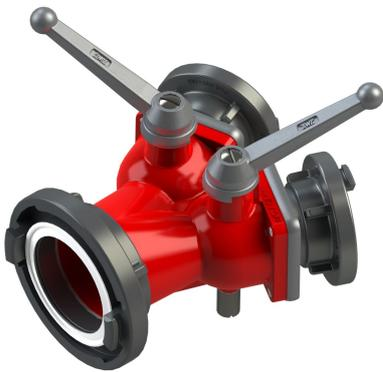
Die AWG Verteiler dienen dazu, das Löschwasser aus einer Leitung in zwei Schlauchleitungen aufzuteilen und somit eine optimale Löschwasserversorgung zu erhalten. Als Absperrorgan dient hier ein Kugelhahn, welches sich schnell und einfach öffnen lässt.
