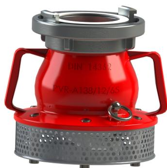
Der AWG Saugkorb dient als Eingang an einer Saugleitung für Löschwasser aus einem offenen Gewässer. Saugkörbe mit Rückschlagventil und Entleereinrichtung verhindern ein Abreißen der Flüssigkeitssäule bei Unterbrechung des Saugvorgangs und ermöglichen ein Auffüllen der Saugleitung. Durch die seilbediente Entleereinrichtung wird das Rückschlagventil geöffnet und der Saugschlauch entleert.
