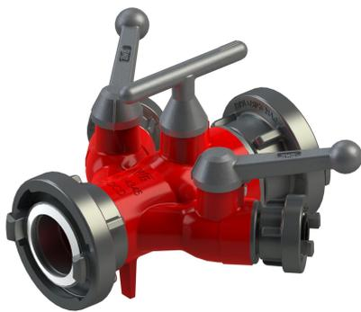
Die AWG Verteiler dienen dazu, das Löschwasser aus einer Leitung in drei Schlauchleitungen aufzuteilen und somit eine optimale Löschwasserversorgung zu erhalten. Als Absperrorgan dient hier ein Kugelhahn, welches sich schnell und einfach öffnen lässt.
