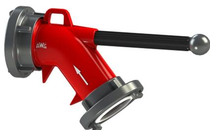
Die AWG Stützkrümmer dienen zur leichteren Handhabung von Strahlrohren, da die Rückstoßkräfte des Wasserstrahls durch Umlenkung über den Schlauch zum Boden abgeleitet werden. Der Stützkrümmer kann auch zwischen 2 Schläuchen gekuppelt werden, wenn diese über Mauerkanten und Fensterbrüstungen gelegt werden müssen.
