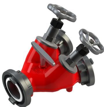
Die AWG Verteiler dienen dazu, das Löschwasser aus einer Leitung in zwei Schlauchleitungen aufzuteilen und somit eine optimale Löschwasserversorgung zu erhalten. Die Ventilabspernung ermöglicht ein sanftes öffnen und schließen der Abgänge.
