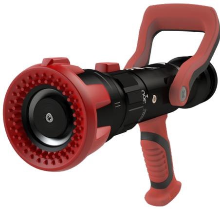
Die Turbo-Spritze EVO 750 ist ein Hohlstrahlrohr nach DIN EN 15182 Funktionskategorie 3 mit einstellbarer Strahlform bei wählbarer konstanter Durchflussmenge 360 / 550 / 750 l/min bei 6 bar. Die Turbo-Spritze EVO 750 ist zum Löschen im Außenbereich geeignet. Eine großzügige Durchflussleistung ermöglicht die Ausbringung von großen Löschwassermengen auf umfassende Brandherde, auch in der typischen Riegelstellung.
