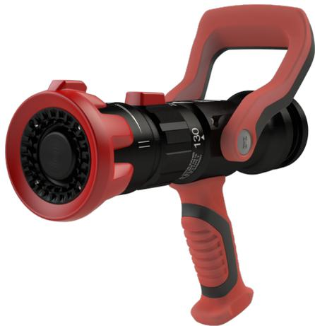
Die Turbo-Spritze EVO 400 ist ein Hohlstrahlrohr nach DIN EN 15182 Funktionskategorie 3 mit einstellbarer Strahlform bei wählbarer konstanter Durchflussmenge 130 / 235 / 400 l/min bei 6 bar. Die Turbo-Spritze EVO 400 ist ausgelegt auf die unterschiedlichsten Arten der Brandbekämpfung. Sie erfüllt zahlreiche nationale und internationale Standards und kann sowohl im Innenangriff als auch im Außenangriff eingesetzt werden.
