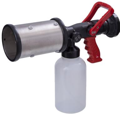
Das AWG Schaumrohr Venturi S/M 75, eine selbstansaugende Schaumrohre, arbeiten nach dem Venturi-Prinzip. Sie vereinen die Funktion von Schaumrohr, Zumischer und Schaummittelbehälter in einem handgeführten Schaumrohr. Der Wasserdurchfluss erzeugt einen Unterdruck, durch den Schaummittel oder Konzentrat aus dem am Strahlrohr befestigten Kunststoffbehälter angesaugt wird. Unter Druck entsteht im Veredlerrohr löschräftiger Schaum. Mögliche Zumischraten sind 1% oder 3%.
