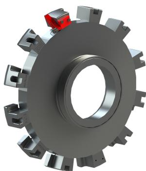
Die symmetrische AWG-Schnellkupplung MultiLug wurde als Verbindungselement für großvolumige Druckschläuche entwickelt. Die Festkupplungen dienen dazu Armaturen miteinander zu verbinden und somit die Löschmittelversorgung zu gewährleisten. Ausgestattet mit einem Innengewinde lässt sich die Festkupplung einfach an eine vorhandenen Armaturen montieren.
