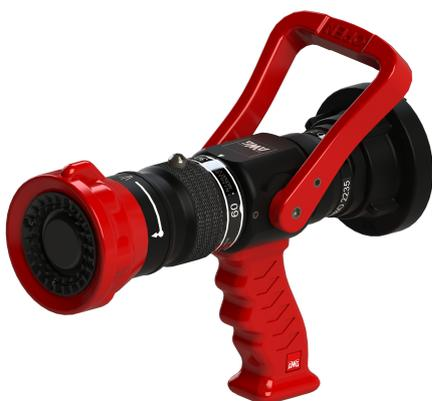
Die AWG Hohlstrahlrohr Turbo-Spritze mit Vollstrahlsperrung sind ausgelegt auf die unterschiedlichen Arten der Brandbekämpfung. Sie können sowohl im Innenangriff als auch im Außenangriff eingesetzt werden. Die zusätzliche Vollstrahlsperrung (kurz VSP) verhindert auf einfachste Art und Weise ein unbeabsichtigtes Umschalten in den Vollstrahl. Die intuitive Bedienung (Strahlrohrkopf nach vorne ziehen) geht leicht von der Hand ohne großen Trainingsaufwand.
