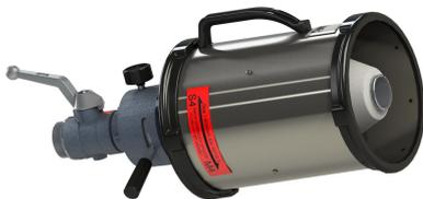
Durch das Umschaltbar Schaumrohr von AWG ist ein gezielter schneller Einsatz von Schwer- und Mittelschaum möglich. Durch ein umschalten des Wahlhebels kann entweder Mittelschaum oder Schwertschaum ausgebracht werden. Es wird entweder das innen- oder außenliegende Rohr mit Wasser-Schaumgemisch versorgt, welches über Wirbelquelle oder Veredlersieb löschkräftigen Schaum erzeugt. Ein Manometer ist serienmäßig eingebaut.
