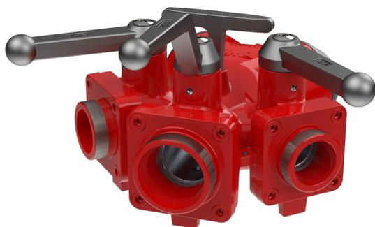
Die AWG Verteiler dienen dazu, das Löschwasser aus einer Leitung in drei Schlauchleitungen aufzuteilen und somit eine optimale Löschwasserversorgung zu erhalten. Als Absperrorgan dient hier ein Kugelhahn, welches sich schnell und einfach öffnen lässt. Die zwei Eingänge des Verteilers ermöglichen eine ununterbrochene Wasserversorgung sicherzustellen.
