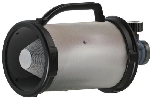
Die AWG Mittelschaumrohre nach DIN EN 16712-3 dienen der Ausbringung von Löschschaum, im Speziellen in Form von Mittelschaum. Das Wasser-/Schaummittelgemisch wird unter Ansaugen von Luft verschäumt und im freien Strahl ausgebracht. Durch das integrierte Veredlersieb wird eine hohe Verschäumung ermöglicht.
