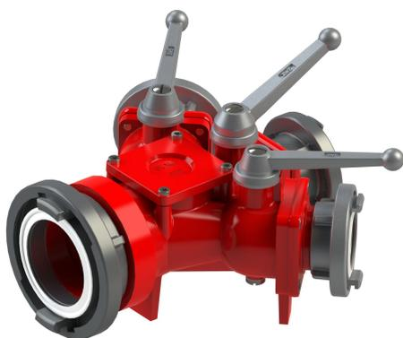
Die AWG Verteiler dienen dazu, das Löschwasser aus einer Leitung in drei Schlauchleitungen aufzuteilen und somit eine optimale Löschwasserversorgung zu erhalten. Als Absperrorgan dient hier ein Kugelhahn, welches sich schnell und einfach öffnen lässt.
